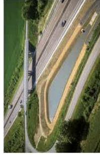
Exemple d'un bassin de traitement d'eaux sur autoroute, pour une bonne gestion environnementale.
